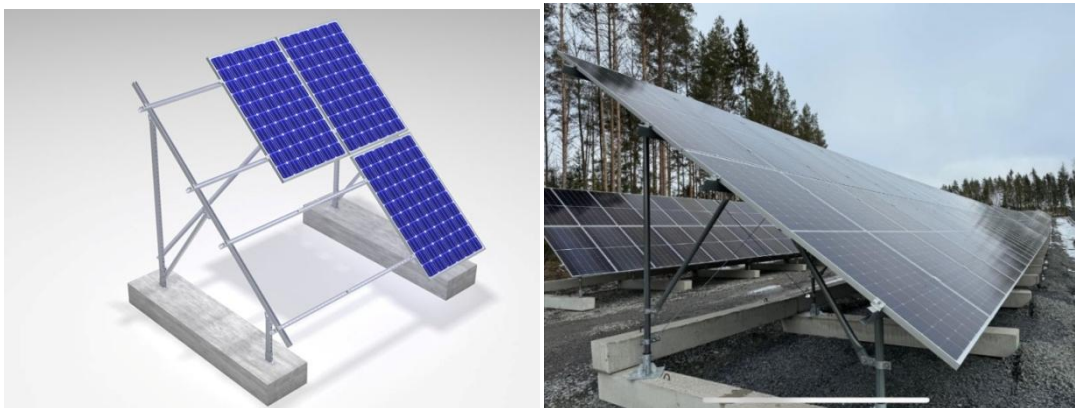
Slika 18 Primer gravitacionih temelja za solarne panele
